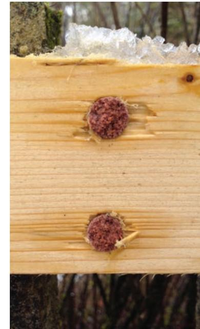
Principe d'assemblage avec tourillons, test de l'effet des conditions extérieures combinées à une contrainte de poids.
