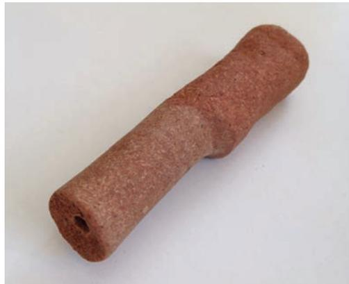
Échantillon test placé en extérieur, avant/après, rongé par des animaux le temps d'une nuit (fin février 2016). © A.Q.
