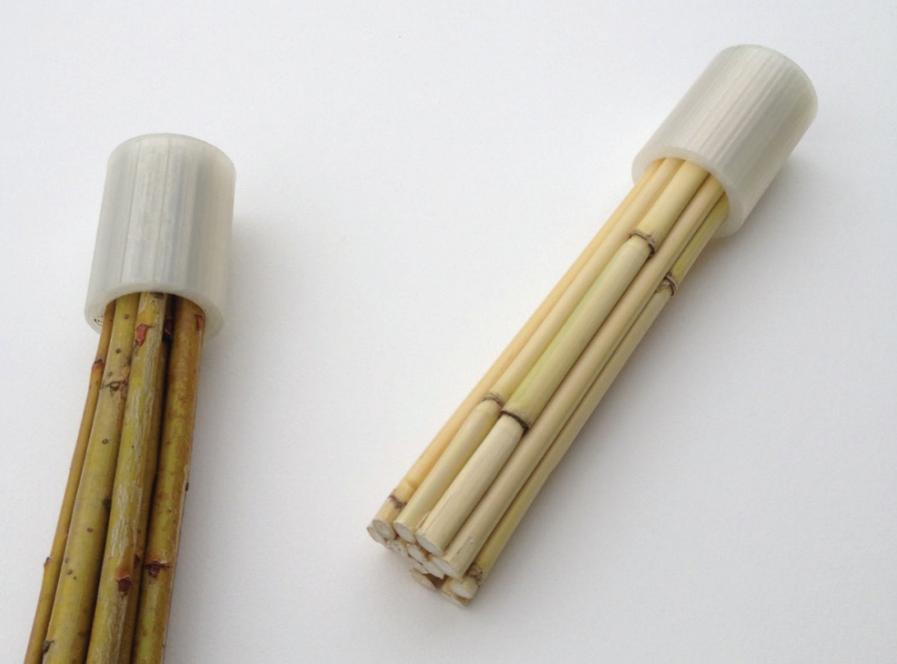
Principes d'assemblages avec de l'osier et du miscanthus, création de bagues pouvant être réalisées en bioplastique © A.Q.
