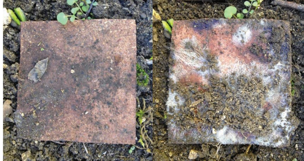
Échantillon test placé en extérieur, dégradation bien visible dès 3 semaines (fin février/ mars 2016) dessus/dessous. © A.Q.
