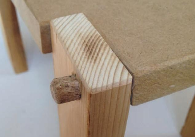
Principe d'assemblage avec tourillons. © A.Q.
