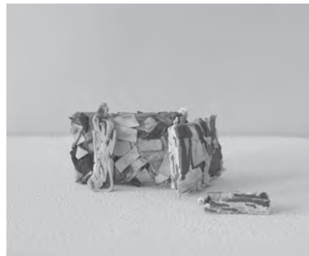
Chutes collées et compactées en briques
