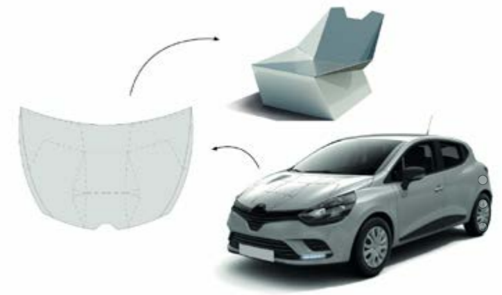
Capot de voiture comportant un patron de découpe pour la réalisation d'une assise en tôle pliée ; Photomontage
