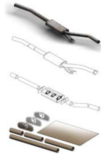
Étapes de démontage d'un pot d'échappement de semi-remorque ; modélisation 3D et photomontage
