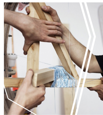
Détail d'assemblage créé par The Thread Wrapping Machine
