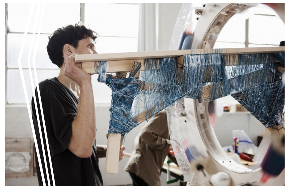
Détail d'assemblage créé par The Thread Wrapping Machine
